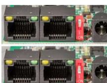
LAN2 порт размещен около переключателя и может бытьключен в режим PoE Out для выдачи питания на сетевое устройство
