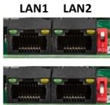
LAN2 порт размещен около переключателя и может быть включен в режим PoE Out для выдачи питания на сетевое устройство
