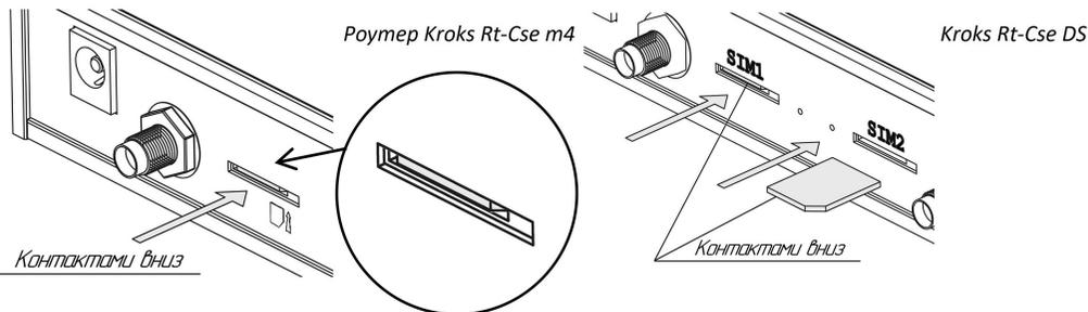
Установку SIM-карты в слот необходимо производить с небольшим усилием, дальше плоскости передней панели до характерного щелчка. **Не допускается использование острых предметов (игла, пинцет и т. д.) для установки SIM-карты ввиду возможной деформации разъёма.**
