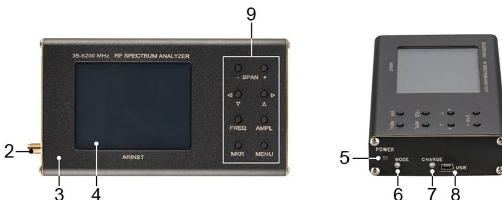
Рисунок 2 – Внешний вид приборов **Arinst SSA Pro R2** и **Arinst SSA Lite R2**
