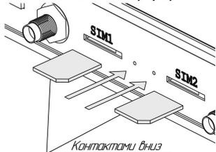
Установку SIM-карты в слот необходимо производить с небольшим усилием, до характерного щелчка. **Не допускается использование острых предметов (игла, пинцет и т. д.) для установки SIM-карты, в виду возможной деформации разъёма.**
