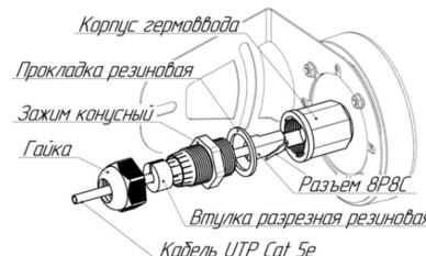
Отвинтите гайку гермовода и разберите его. Пропустите витую пару с разъемом как указано на схеме и подключите к LAN-порту внутри гермовода. Соберите гермовод.
