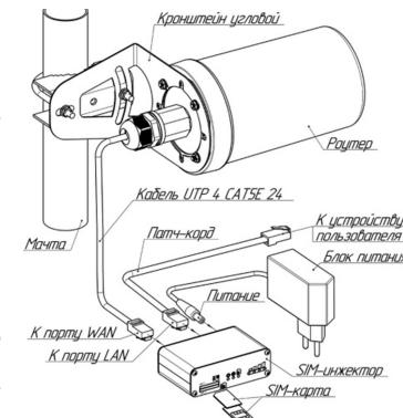
Другой конец кабеля подключите к сим-инжектору. Общая схема подключения представлена на схеме.
