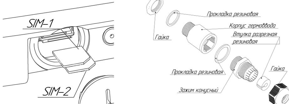
Данный комплект поставляется в собранном виде и готов к использованию. Это значит, что **внутри герметичного корпуса антенны роутер уже подключен пigtейлами к разъемам антенны и кабель гермоввода подключен к LAN-порту роутера.**
