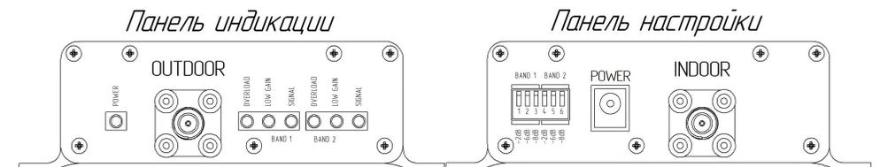
Рисунок 2 – Панели усилителя
