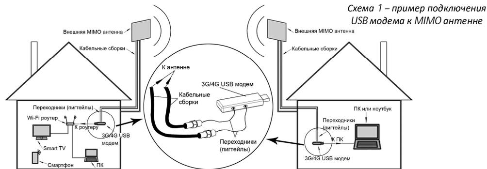
Схема 1 – пример подключения USB модема к MIMO антенне
